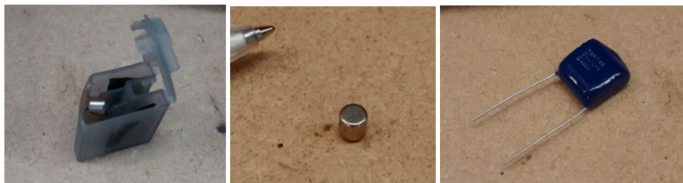
Onderdelen die bij het repareren van Senseo-koffieapparaten van pas komen. Links: verroest magneetje in de vlotter, midden: nieuw magneetje, rechts: condensator.
